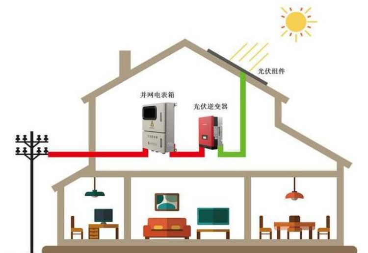
图 27 太阳能光伏系统原理图
