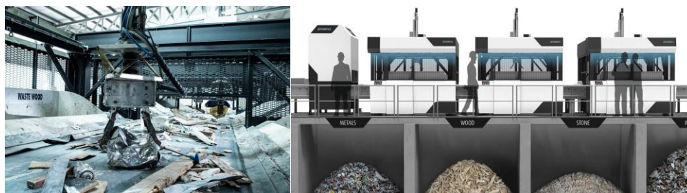
图 34: ZenRobotics 人工智能废物分离器
